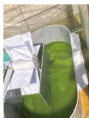
下水二次処理水を用いた油生産藻類の培養の様子
